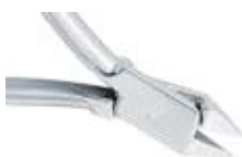
Щипцы Адамса Maxi С двумя гладкими прямоугольными щечками. Максимальная толщина проволоки Ø: 0.8 мм, жесткая
